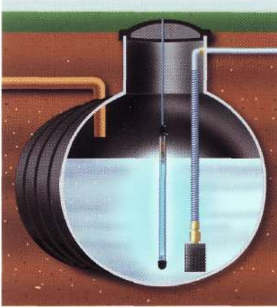
UV-Tauchlampen halten Wasser in Tanks keimfrei.
